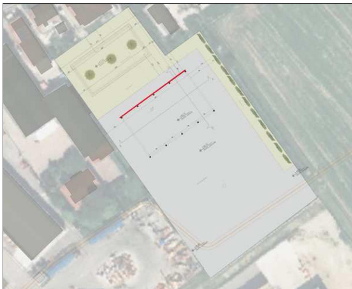
Figura 6.5.3 Lato della tettoia chiusa con una parete
